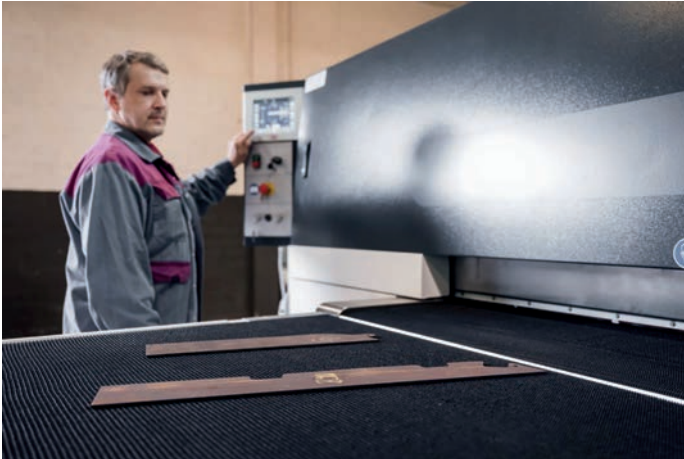
Die zu bearbeitenden Bleche laufen automatisch durch die Maschine. Dabei bürsten die vier Bürstriemeneinheiten die Oxidschichten auf allen Innen- und Aussenkanten ab.
