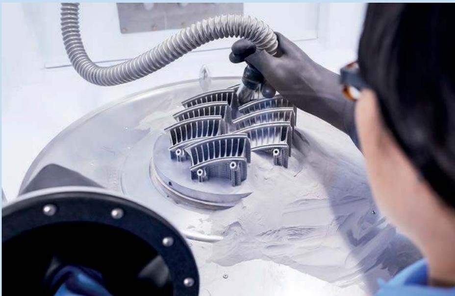
Im Auftrag von Toolcraft hat Trumpf ein Vane, das bei Flugzeugmotoren zum Einsatz kommt, mit 3D-Druck hergestellt. Gesamtersparnis: 20 Prozent.
