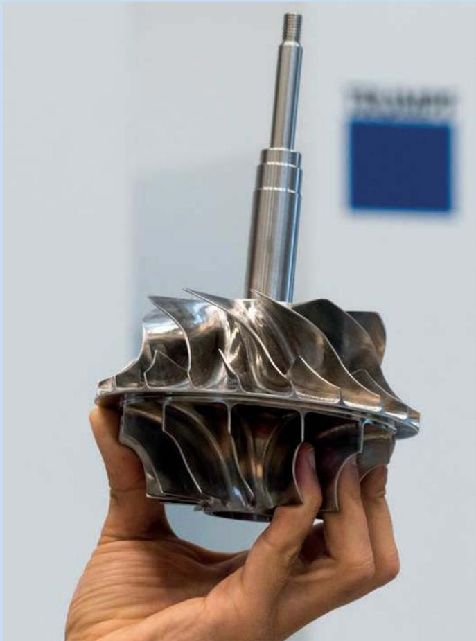
Trumpf hat das Laufwerk für einen Gaskompressor mit 3D-Druck gefertigt und dabei die Bearbeitungszeit halbiert.
