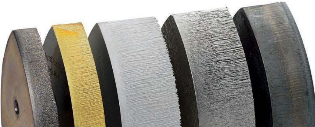
Hochwertige Schnitte in Blechstärken bis 30 mm: Das ermöglicht die Option Power Cut Fiber.
