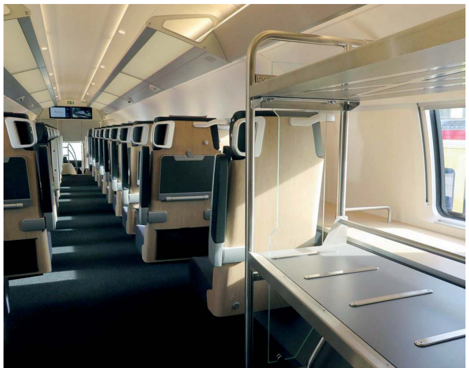
Produkte der Blechtech AG: Deckenverkleidungen wie Abdeckrollo aus Aluminium, pulverbeschichtet, mit Unterkonstruktion geklebt; Gepäckablagen aus Okume, beschichtet, montiert, in Chromstahlunterkonstruktion geklebt.
