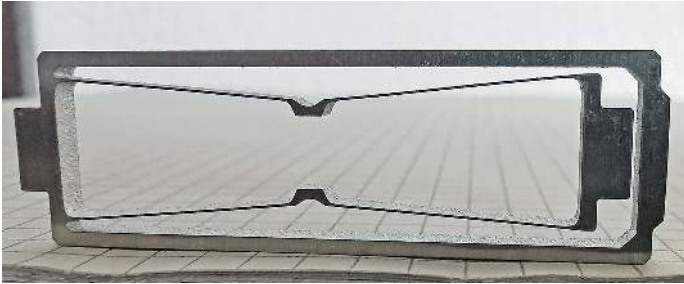
Die filigranen Stege dieses aus einem 2,5 mm dicken Alublech geschnittenen Bauteils sind nur 200 µm dick.
