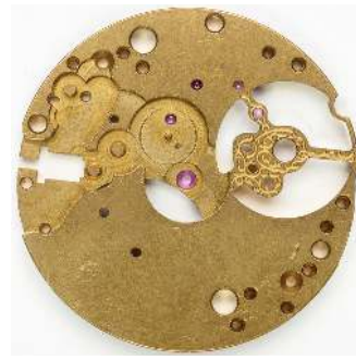
Mit dem Wasserstrahl nach dem Einpressen der Rubine geschnittene Uhrenplatine.
