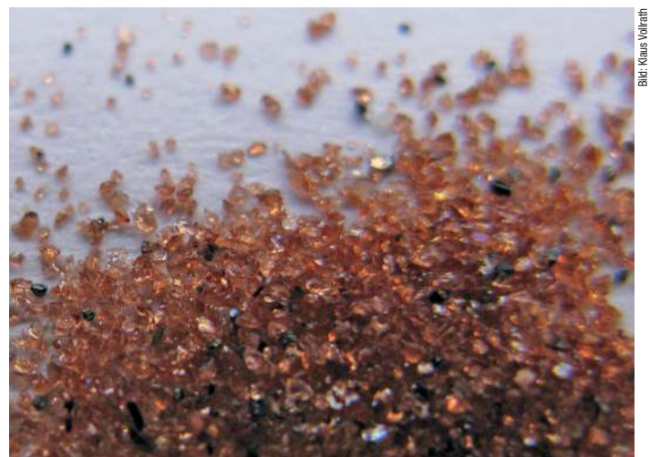
Als Abrasivstoff kommt beim Wasserstrahlschneiden bevorzugt Granatsand in unterschiedlichen Korngrössen zum Einsatz.
